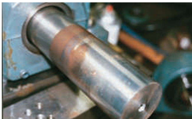
Cojinete de tornillo de fijación tras 500 horas
